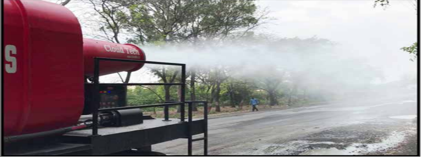
चित्र: एनसीएल के निगाही ओसी पर धूल दमन के लिए फॉग कैनन
