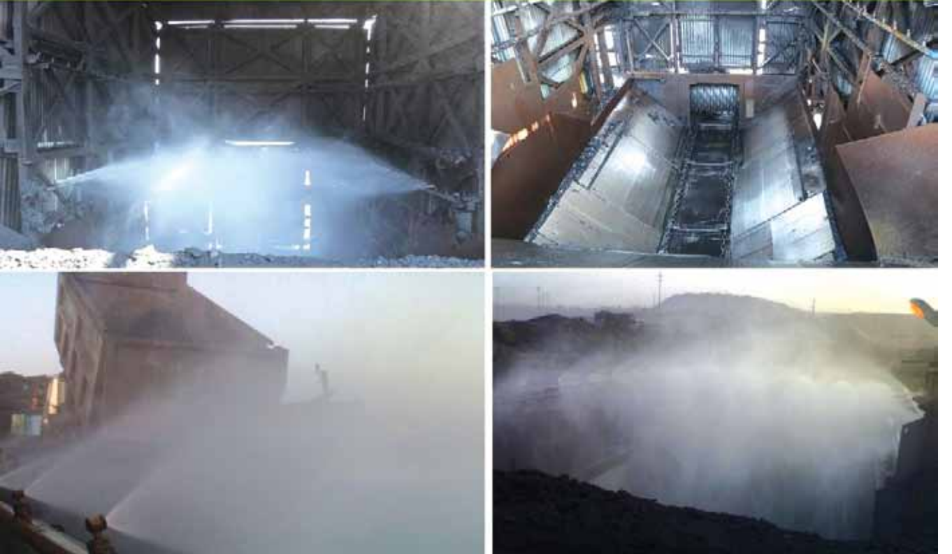
चित्र: गेवरा ओसीपी, एसईसीएल में मिस्ट स्प्रेडिंग व्यवस्थाओं के साथ फीडर ब्रेकर
