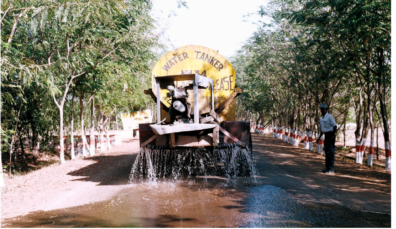
वेस्टर्न कोलफील्ड्स लिमिटेड के महाराष्ट्र स्थित वणि क्षेत्र में धूल की रोकथाम के लिए वॉटर स्पिंकलर का उपयोग
