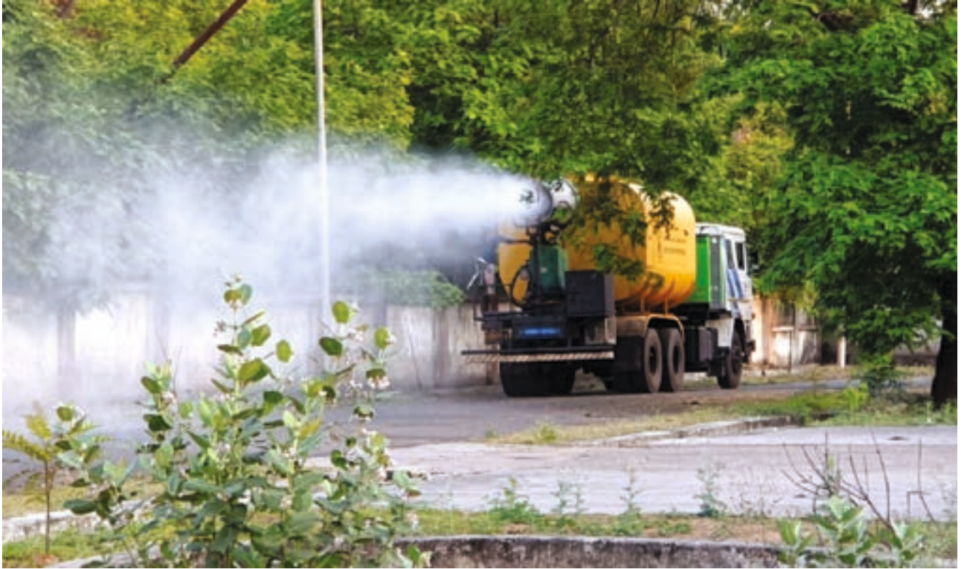
साउथ ईस्टर्न कोलफील्ड्स लिमिटेड के छत्तीसगढ़ स्थित दीपका क्षेत्र में कार्यरत फॉग कैनन
