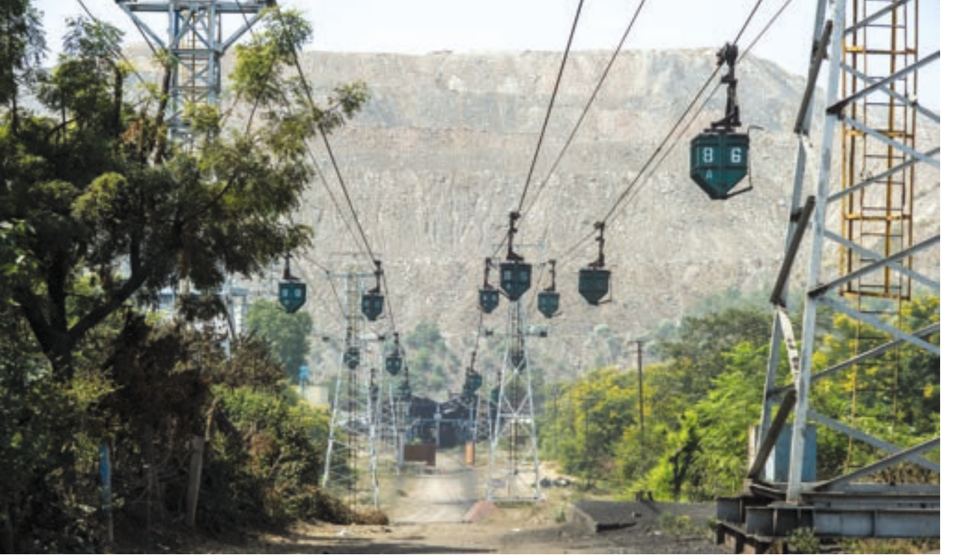
नॉर्दर्न कोलफील्ड्स लिमिटेड के उत्तर प्रदेश स्थित ककरी क्षेत्र में रोपवे के जरिये कोयला परिवहन
