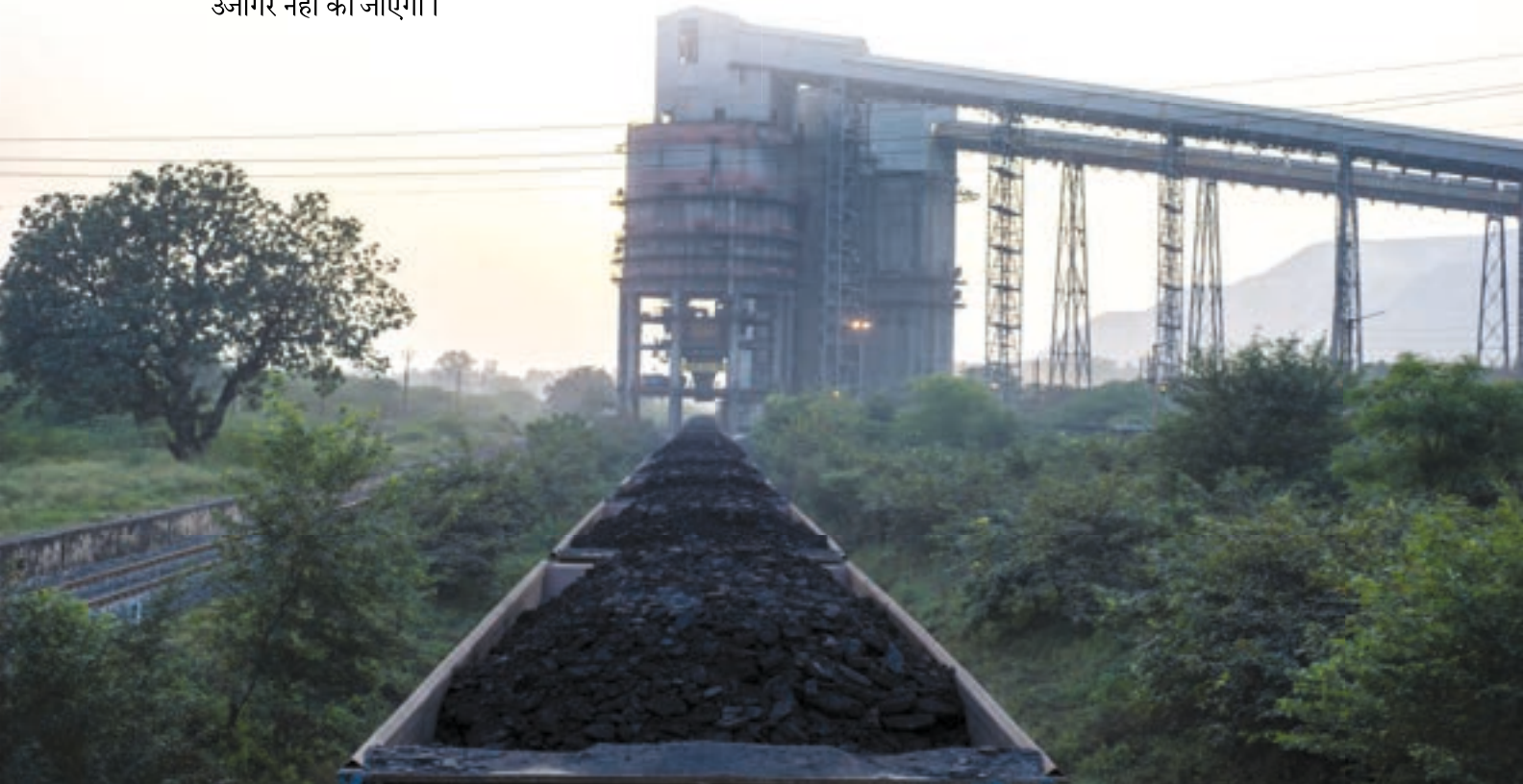
नॉर्दन कोलफील्ड्स लिमिटेड के उत्तर प्रदेश स्थित दुधिचुआ क्षेत्र से मेरी-गो-राउंड के जरिये कोयले का परिवहन
