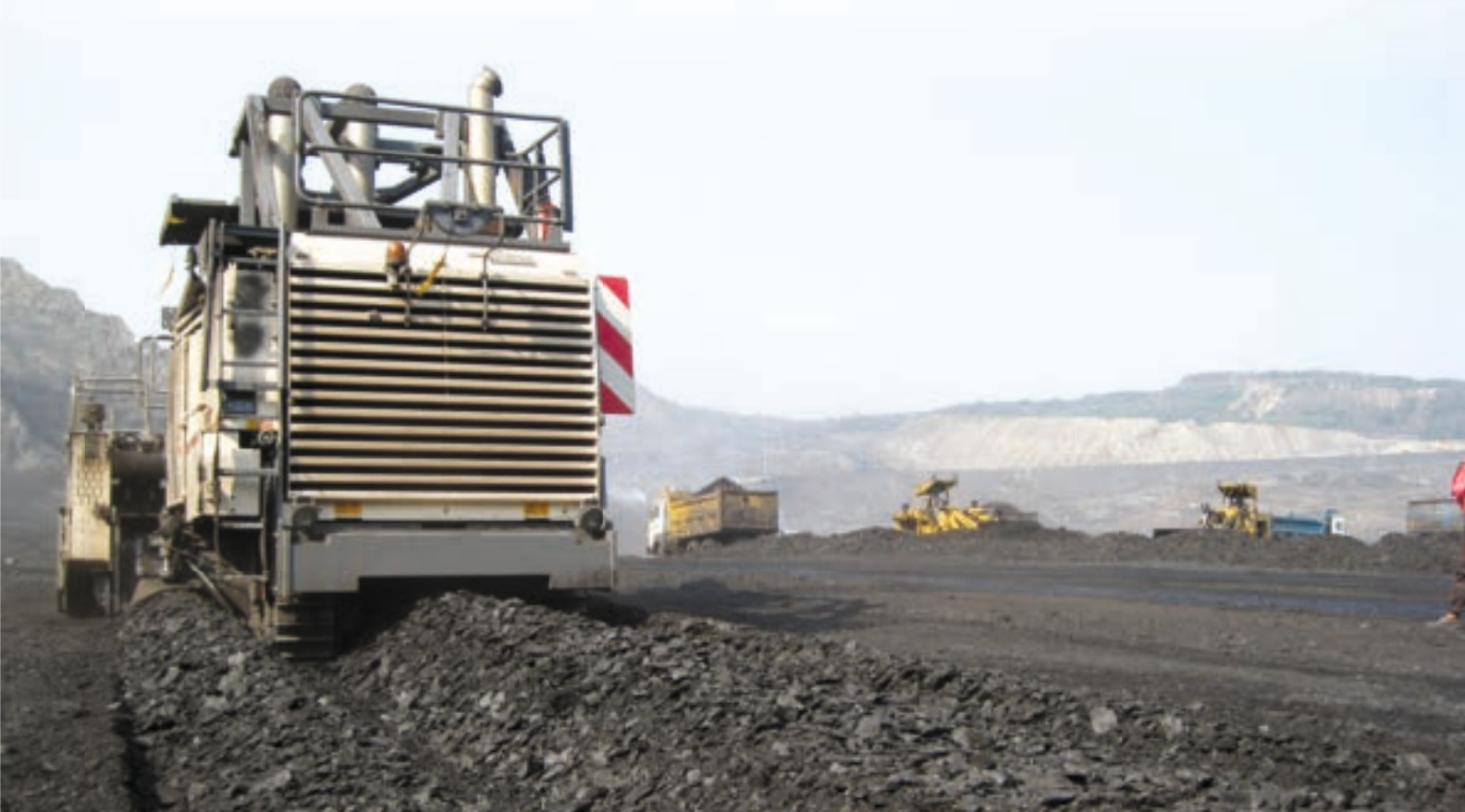
साउथ ईस्टर्न कोलफील्ड्स लिमिटेड के छत्तीसगढ़ स्थित गेवरा क्षेत्र में कार्यरत ईको-फ्रेंडली 'सरफेस माइनर'
