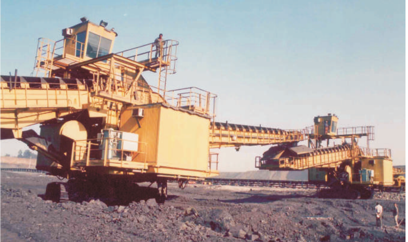
पीपरवार ओसीपी में आधुनिक ओपन कास्ट खनन मशीन, ईन-पिट कोयला क्रशर प्रचालन में
